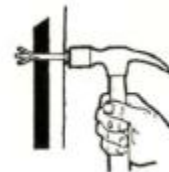
Sett inn pinnen og slå den inn slik at pluggen sitter fast.
